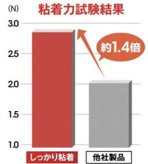
※ひっぱり試験機 STA-1225にて、PP板使用による、180度はく離法での粘着力を測定
